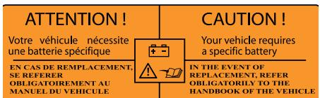
В данной табличке, особенно если речь идет о системе "стоп-старт", указывается, что на автомобиле используется 12-вольтная свинцово-кислотная аккумуляторная батарея с особыми технико-эксплуатационными характеристиками, и что ее отключение или замена должны осуществляться только в условиях сервисной сети CITROËN или специализированного технического центра.
