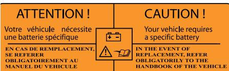
**i** В данной табличке, особенно если речь идет о системе "Стоп-Старт", указывается, что на автомобиле используется 12-вольтная свинцово-кислотная аккумуляторная батарея с особыми технико-эксплуатационными характеристиками, и что ее отключение или замена должны осуществляться только в условиях сервисной сети CITROËN или специализированного техцентра. Несоблюдение этих требований может привести к снижению срока службы батареи.
