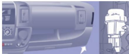
Для восстановления электропитания нажмите на вторую кнопку, расположенную в отсеке АКБ под полом со стороны водителя (на микроавтобусе).
