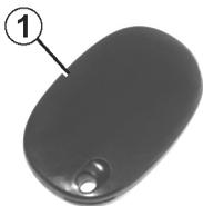
Приемопередатчик **1**, если автомобиль им оснащен, помимо функций дистанционного управления, может использоваться для запираания и отпираания дверей без использования пульта дистанционного управления. Для этого устройство должно находиться в зоне доступа **2**.
