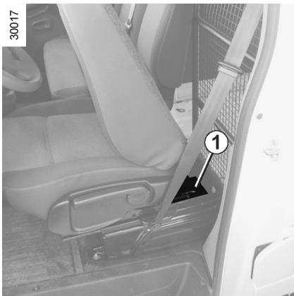
В зависимости от комплектации автомобиля в случае прокола шины используйте комплект накачивания **1**, находящийся под сиденьем водителя.
