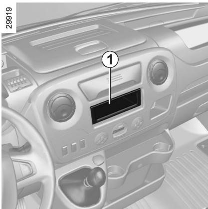
Если ваш автомобиль не оборудован аудиосистемой, то для нее существует подготовка в виде мест для установки:
