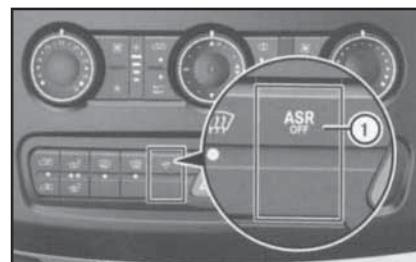
36.1 Кнопка (1) отключения антипробуксовочной системы (ASR)
