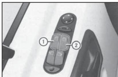
**4.19 Переключатели управления функционированием электропривода стеклоподъёмников главной панели переключателей на сборке водительской двери автомобиля**
