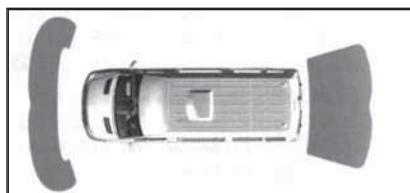
**38.3б Зоны действия датчиков PTS (2 из 2)**
