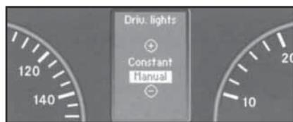
17.17a Вид экрана многофункционального дисплея с выведенной функцией выбора режима функционирования фар - раздел "Освещение" меню "Установки"
