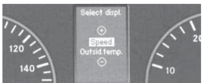
17.15e Вид экрана многофункционального дисплея с выведенной функцией выбора типа данных (температура наружного воздуха/скорость), выводимых на базовую страницу меню "Эксплуатация" - раздел "Комбинация приборов" меню "Установки"
