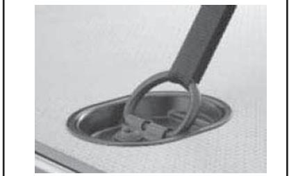
**20.1 Местоположение и пример использования проушин (1) для раскрепления багажа в задней части салона микроавтобуса (ещё две проушины симметрично расположены с правого борта автомобиля)**
