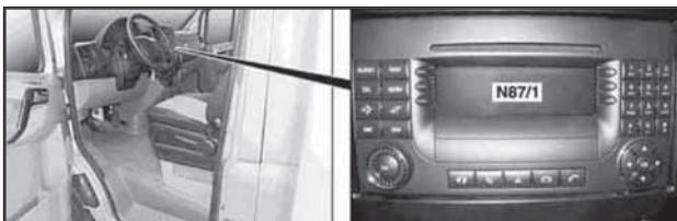
7.45a Местоположение и конструкция блока (N87/1) управления радиоприёмника/навигационной системы в варианте исполнения Sound 50 APS (комплектация "код EN8")
