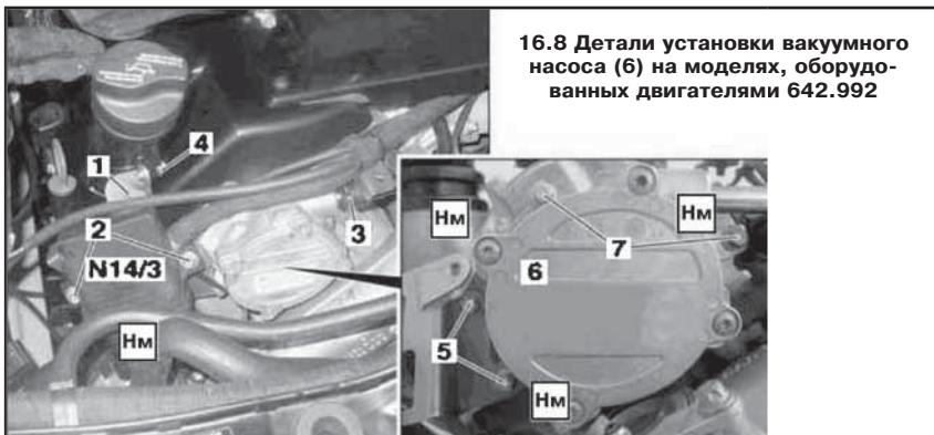
16.8 Детали установки вакуумного насоса (6) на моделях, оборудованных двигателями 642.992
