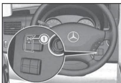
37.1 Выключатель (1) активации/деактивации полноприводного режима на моделях с подключаемым полным приводом
