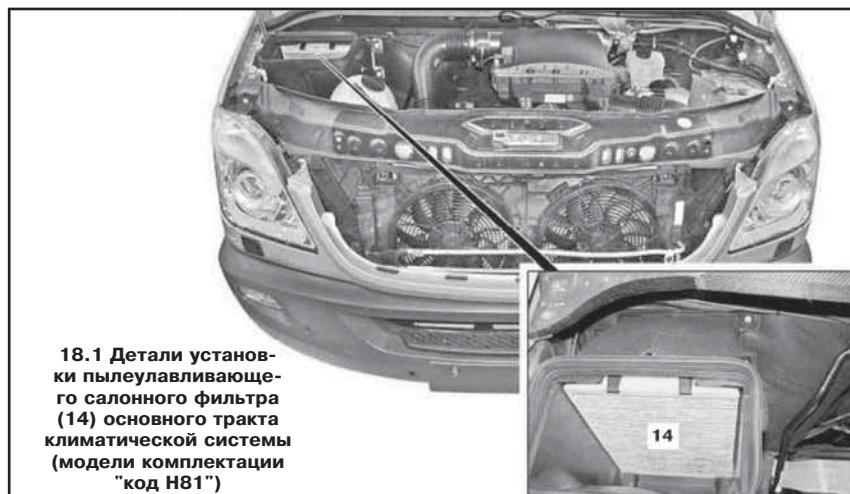
**18.1** Детали установки пылеулавливающего салонного фильтра (14) основного тракта климатической системы (модели комплектации "код H81")
