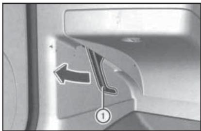
6.1 Для отпускания защелки замка капота потяните на себя (стрелка) расположенную в водительском ножном колодце приводную рукоятку (1)
