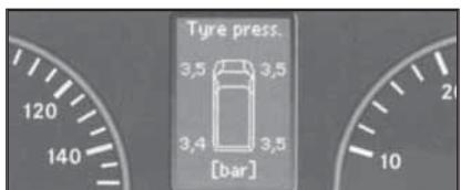
17.7в Вид верхнего экрана многофункционального дисплея при выбранной странице "Давление накачки шин" меню "Эксплуатация"
