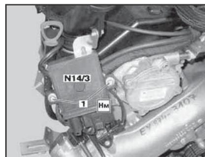
5.9 Детали установки выходного модуля (N14/3) системы накала на моделях, оборудованных двигателями ОМ 642
