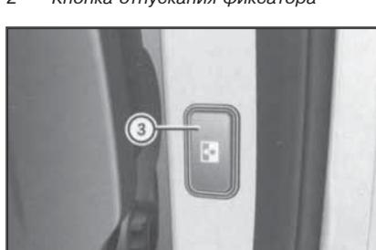
**4.6 Индивидуальный переключатель (3) управления функционированием электропривода сдвижной двери установлен в проёме последней**
