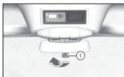
**18.16** Рычажок (1) переключения режимов салонного зеркала заднего вида вмонтирован в нижнюю часть корпуса последнего
