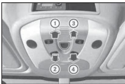
**4.23 Принцип управления функционированием электропривода подъёмно-сдвижного верхнего люка**
