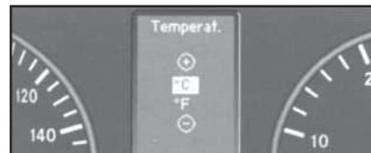
17.15а Вид экрана многофункционального дисплея с выведенной функцией выбора единиц измерения показаний датчиков температуры - раздел "Комбинация приборов" меню "Установки"
