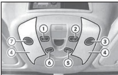
**18.13в** Приборы освещения передней части салона и переключатели управления их функционированием на моделях с главной потолочной консолью в варианте исполнения II
