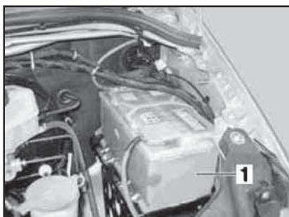
5.55 Местоположение дополнительной аккумуляторной батареи (1) в двигательном отсеке автомобиля
