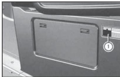
**1 Табличка с VIN и данными по допустимым уровням весовых нагрузок помещается на каркасе сиденья**
