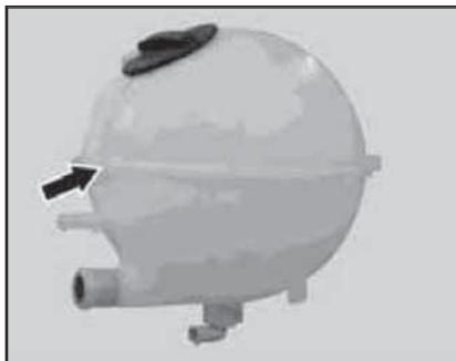
**22.21** При заправке системы охлаждения свежей охлаждающей жидкостью уровень последней должен подняться приблизительно на 10 мм выше установочной метки (стрелка)
