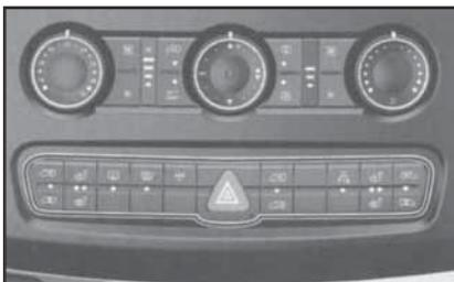
**18.9 Схема расположения переключателей на центральной консоли автомобиля**
