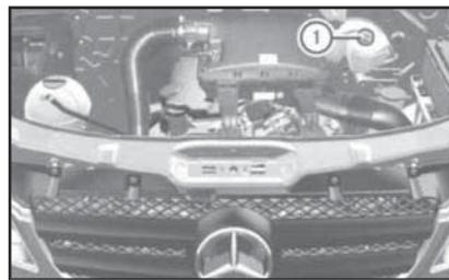
**5.33 Местоположение резервуара тормозной жидкости и - на моделях с РКПП - жидкости гидропривода сцепления (на примере моделей с двигателем OM 646)**
