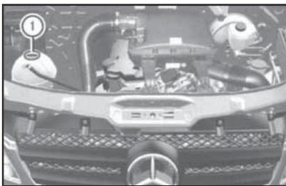
**5.24 Местоположение расширительного бачка системы охлаждения (на примере моделей с двигателем OM 646)**
