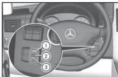
**18.7** Переключатель комфортаельного управления функционированием приборов освещения задней части салона на моделях Микроавтобус и Фургон соответствующей комплектации
