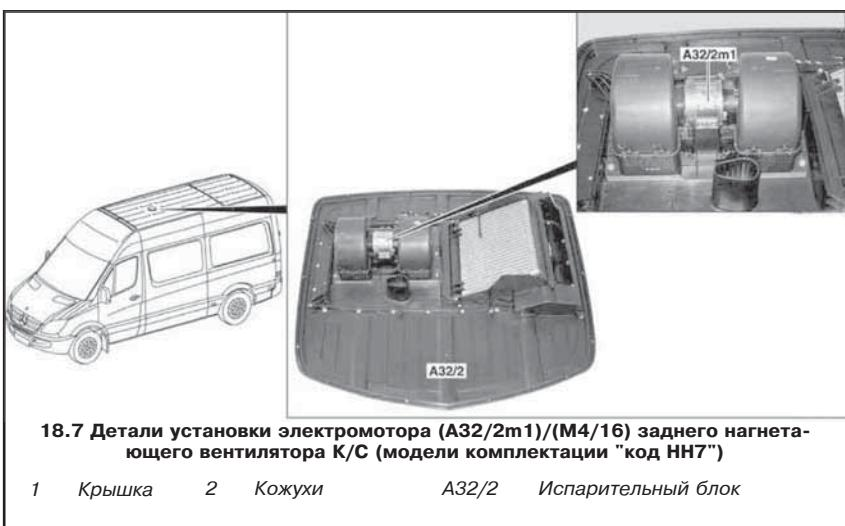
**18.7 Детали установки электромотора (A32/2m1)/(M4/16) заднего нагнетающего вентилятора К/С (модели комплектации "код НН7")**
