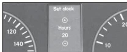
17.16a Вид экрана многофункционального дисплея с выведенной функцией установки параметров времени суток (раздел "Часы/Дата" меню "Установки") на примере режима корректировки значения часа (в режиме установки минут страница выглядит аналогично, с той лишь разницей, что вместо подзаголовка "Hours" будет стоять подзаголовок "Minutes")
