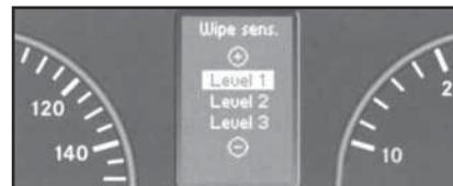
17.18c Вид экрана многофункционального дисплея с выведенной функцией установки уровня чувствительности датчика дождя - раздел "Автомобиль" меню "Установки" (модели соответствующей комплектации)
