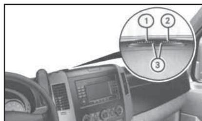
**38.4а Местоположение и конструкция светового индикатора контроля передней зоны риска (PTS)**
