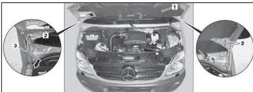
5.1 Детали установки капота (1)
