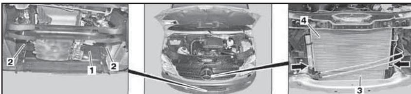
5.62 Детали установки теплообменник (3) охлаждения воздуха наддува (все двигатели)
