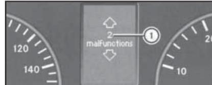
17.12 Вид верхнего экрана многофункционального дисплея в режиме индикации неисправностей при наличии записей о таковых в памяти бортового процессора
