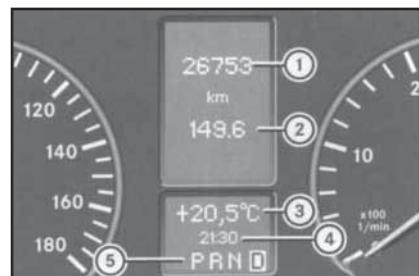
17.6 Вид базовой страницы меню "Эксплуатация" многофункционального дисплея
