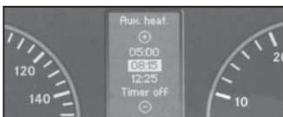
17.19 Вид экрана многофункционального дисплея с выведенной функцией выбора таймера активации автономного дополнительного жидкостного отопителя - раздел "Автомобиль" меню "Установки" (модели соответствующей комплектации)
