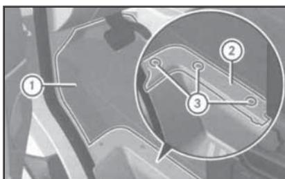
18.30 Детали крепления панели (1) коврового покрытия водительского ножного колодца
