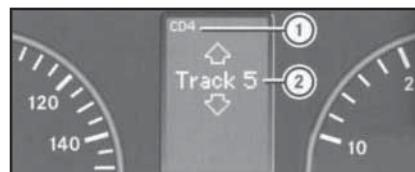
17.9 Вид верхнего экрана многофункционального дисплея в режиме выбора трека компакт диска CD-плеера/чейнджера (меню "AUDIO")
