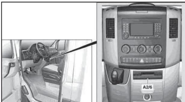
7.47 Местоположение штатного CD-чейнджера (A56) (модели комплектации "код EP5")
