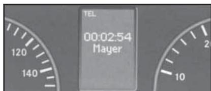
17.27 Вид экрана меню "Телефон" при установке соединения после ответа вызываемого абонента на звонок
