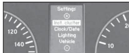
17.14 Вид страницы с перечнем вложенных разделов меню "Установки" ("Settings") многофункционального дисплея, - при входе в перечень подсвечивается первый в списке раздел
