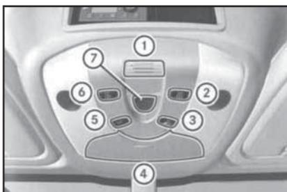
**16.4 Схема расположения элементов управления на сборке главной потолочной консоли (на примере варианта II исполнения консоли, - вид консоли в варианте исполнения I показан на иллюстрации 18.13а)**
