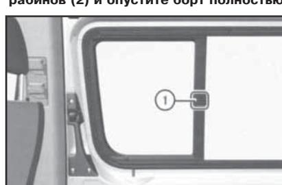
**4.20 Для отпускания фиксатора (1) сдвижного стекла сожмите вместе его половины**
