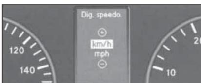
17.15б Вид экрана многофункционального дисплея с выведенной функцией выбора единиц измерения показаний цифрового спидометра - раздел "Комбинация приборов" меню "Установки"
