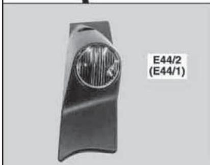
16.44 Местоположение верхних габаритных огней (E44/2)/(E44/1) на моделях с бортовой платформой комплектации "код L07"
