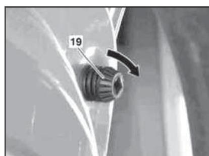
22.37 Регулировка положения верхнего и нижнего буферных элементов (19) двери
