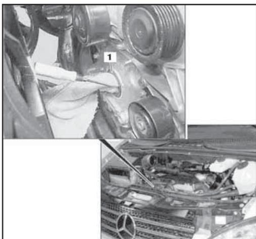
**6.1b Извлечение старого переднего сальника (1) коленчатого вала двигателя OM 642**
