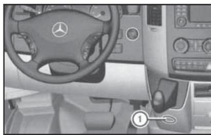
34.2 Отверстие сервисного отверстия аварийного снятия блокировки селекторного рычага АТ защищено декоративной заглушкой (1)
