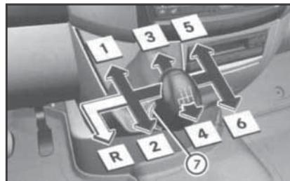
33.1 На торцевую поверхность рукоятки рычага РКПП нанесена схема переключения передач
