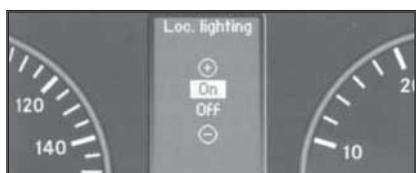
17.17b Вид экрана многофункционального дисплея с выведенной активацией/деактивацией подсветки пространства вокруг автомобиля - раздел "Освещение" меню "Установки"
