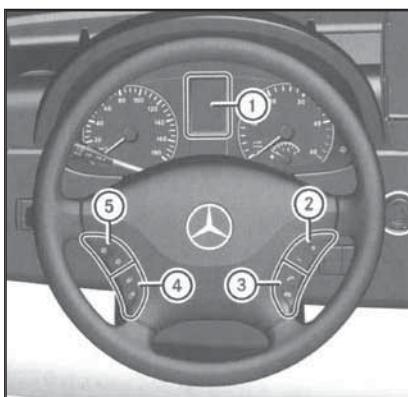
16.3 Схема расположения элементов управления на сборке многофункционального рулевого колеса
