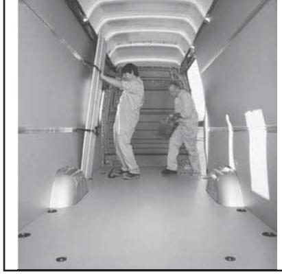
**20.3 Принцип использования устанавливаемых на стенах/полу грузового отсека фургона крепёжных реек**
