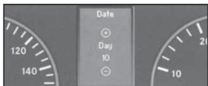
17.16c Вид экрана многофункционального дисплея с выведенной функцией установки даты (раздел "Часы/Дата" меню "Установки") на примере режима установки числа (в режимах установки месяца/года страница будет выглядеть аналогично, с той лишь разницей, что вместо подзаголовка "Day" будет стоять подзаголовок "Month"/"Year")
