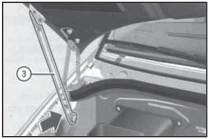
6.3 Фиксация капота в открытом положении производится при помощи бокового упора (3), - проследите, за надёжностью срабатывания блокиратора (стрелка) нижнего конца упора
