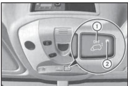
**8.1 Выключатель (1) деактивации функции защиты от буксировки**
