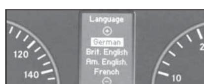
17.15г Вид экрана многофункционального дисплея с выведенной функцией выбора языка интерфейса меню - раздел "Комбинация приборов" меню "Установки"
