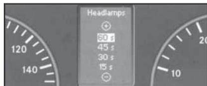
17.17c Вид экрана многофункционального дисплея с выведенной функцией установки времени задержки отключения бортовых огней - раздел "Освещение" меню "Установки"
