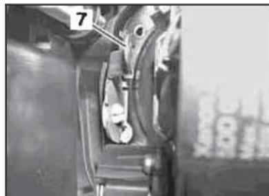
12.3 Регулировка наклона оптических осей фар (E1/E2) ксенонового и биксенонового типа производится путём смещения подвижной крышки рефлектора, оснащённой специальным регулировочным рычажком (7)
