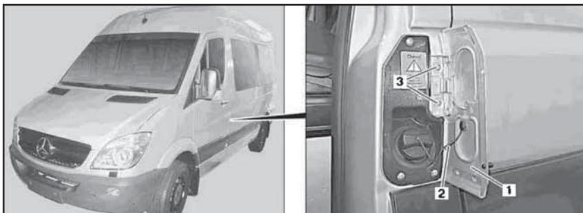
13.1 Детали установки крышки (1) лючка заливной горловины топливного бака
