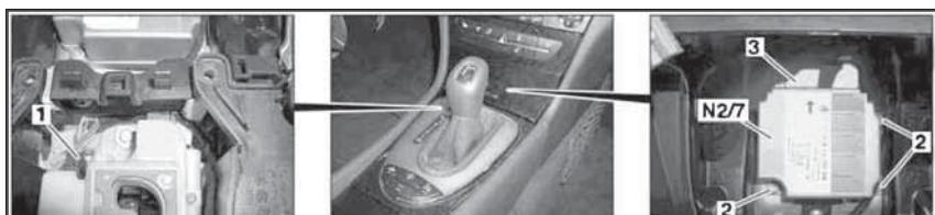
21.1 Детали установки блоков (N2/14)/(N2/15) управления SRS
