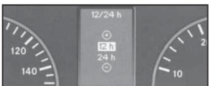
17.16b Вид экрана многофункционального дисплея с выведенной функцией выбора формата отображения времени (12/24) - раздел "Часы/Дата" меню "Установки"
