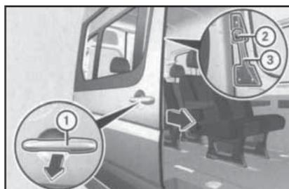
**4.4 Открывание/закрывание открытой сдвижной двери производится при помощи наружной (1), либо внутренней (3) ручки**
