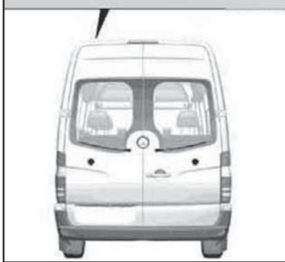
16.57 Местоположение дополнительных верхних повторителей указателей поворотов (E22/6)/(E22/7) на моделях Микроавтобус и Фургон комплектации "код LB3"
