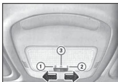
18.13а Выбор режима функционирования переднего салонного светильника на моделях с главной потолочной консолью в варианте исполнения I
