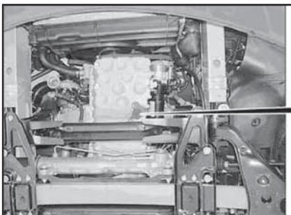
20.31 Детали установки датчика (B40) уровня двигателя масла (двигатели ОМ 646)
