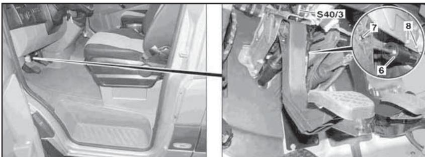
4.1б Детали установки главного цилиндра (6) привода выключения сцепления (2 из 2)
