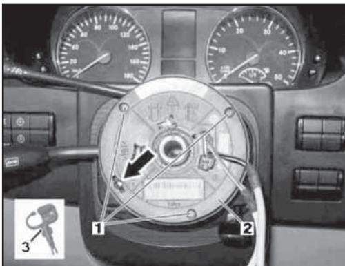
**21.1а Детали установки контактного кабельного барабана (2) \ электропроводки кнопки клаксона и модуля водительской фронтальной подушки безопасности**
