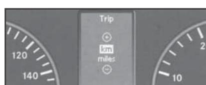
17.15в Вид экрана многофункционального дисплея с выведенной функцией выбора единиц измерения показаний одометра/обнуляемого счетчика пробега - раздел "Комбинация приборов" меню "Установки"
