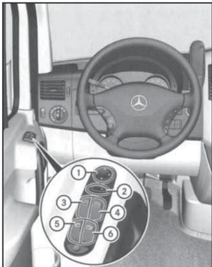
16.2 Схема расположения элементов управления на сборке водительской двери
