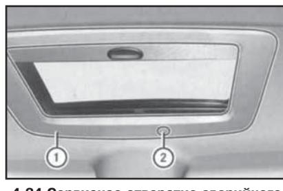
**4.24 Сервисное отверстие аварийного привода крышки верхнего люка помещается в задней кромке панели (1) облицовки проёма крыши и оборудовано декоративной заглушкой (2)**
