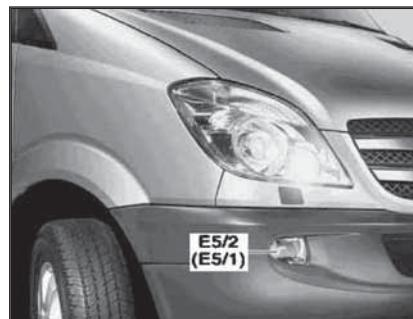
16.25 Местоположение противотуманных фар (E5/2)/(E5/1) на моделях Микроавтобус/Фургон комплектации "код L16"
