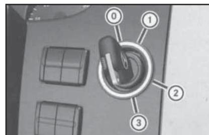
**18.8** Замок "зажигания" имеет четыре фиксированных положения (см. текст)
