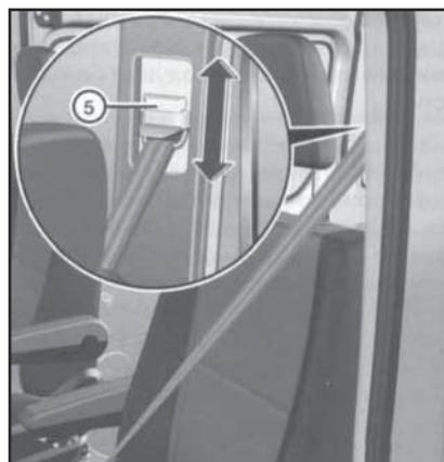
10.3 Отпускание фиксатора верхнего анкера плечевой секции ремня безопасности переднего сиденья производится при помощи кнопки (5) (на примере ремня водительского сиденья)
