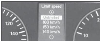
17.18a Вид экрана многофункционального дисплея с выведенной функцией установки значения постоянного ограничения максимальной скорости движения - раздел "Автомобиль" меню "Установки" (модели, оборудованные темпоматом с функцией Permanent Speedtronic)
