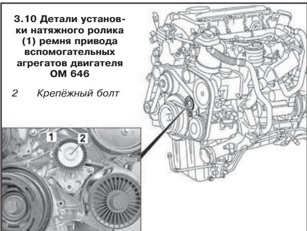
**3.10 Детали установки натяжного ролика (1) ремня привода вспомогательных агрегатов двигателя OM 646**
