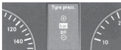
17.15f Вид экрана многофункционального дисплея с выведенной функцией выбора единиц измерения показаний датчиков давления воздуха в шинах - раздел "Комбинация приборов" меню "Установки"
