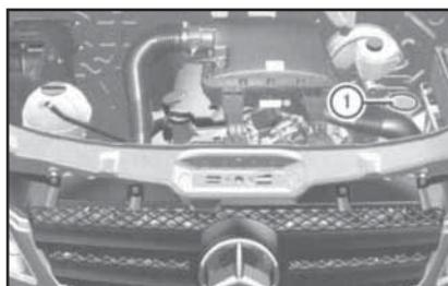
5.57 Местоположение резервуара жидкости омывания стёкол/линз фар
