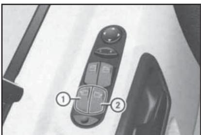
**4.22 Переключатели управления функционированием электропривода поворотных стёкол входят в состав главной панели переключателей на сборке водительской двери автомобиля**
